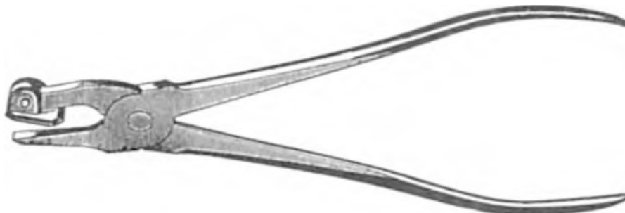
Рис. 48. Плоскогубці для вирiвнювання клавiш. Щелепи залишаються паралельними, поки ви стискаєте дерево
