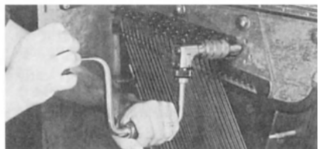
Рис. 31. Використання напівдюймового електродрілю з регульованою швидкістю та реверсом для зняття вірбелів
