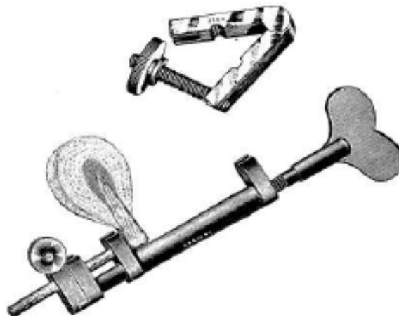
Розбирання молоточка піаніно за допомогою екстрактора із затискачем.
