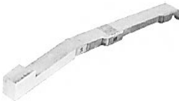
Рис. 51 Ремонт зламаної білої клав'їші
