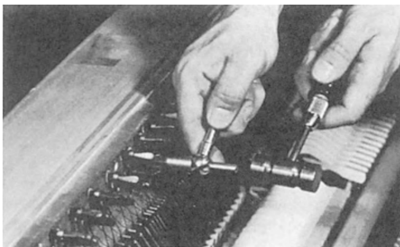
Рис. 26. Показано, як вбивати один ослаблений вірбель, використовуючи маленький молоток для комбінованої ручки, що зручно носити в інструментальному ящику
