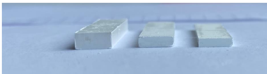
Рис. 3.2. Вигляд пресованих зразків різної маси, одержаних із комерційного порошку ZrO_2
