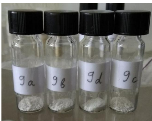
Рис. 3.1. Порошки ZrO_2 , кальциновані за різної температури: (9a) – 400 °С; (9b) – 500 °С; (9c) – 600 °С; (9d) – 700 °С
