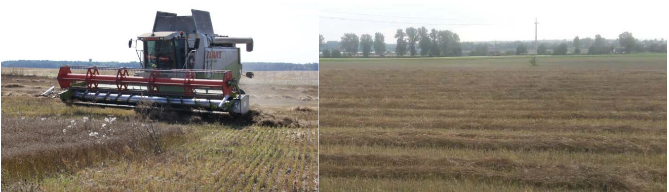
Рис. 1 Пряме(а) комбайнування та роздільний спосіб збирання(б): вкладання стеблостою льону олійного у валки роторною косаркою
