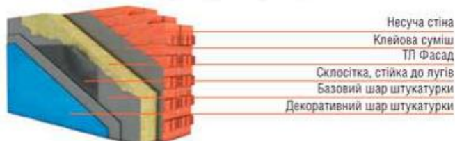
Рис. 1. Конструктивно-технологічне рішення зовнішнього утеплення
