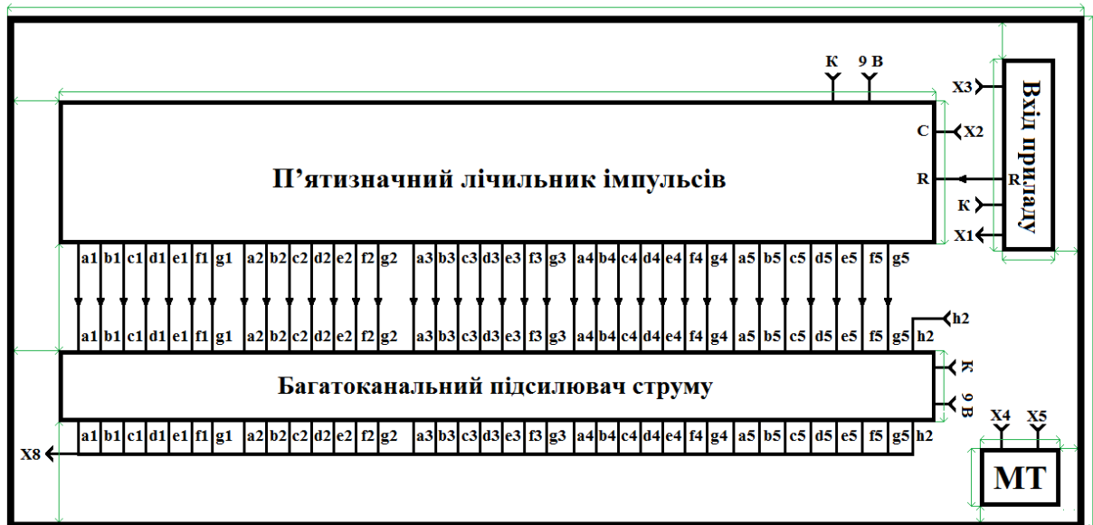
Рис. 2.9. План розташування відповідних плат на внутрішній задній стінці
