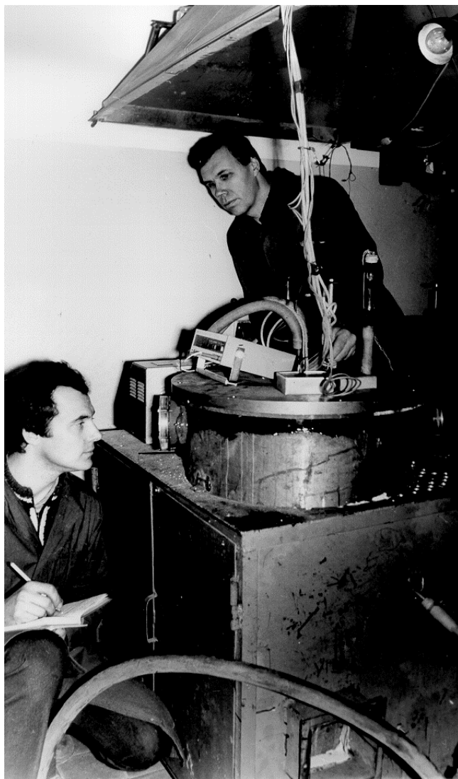
Рис. 6.2.4 Робота на вакуумній рідкометалевій установці: руйнування рідкометалевої плівки за допомогою електромагнітних полів; спостереження за процесом через оглядові вікна
