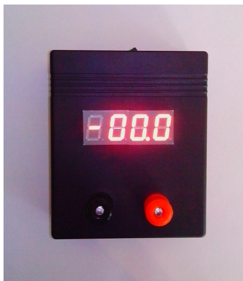
Рис. 4. Зовнішній вигляд розробленого цифрового вольтметра
