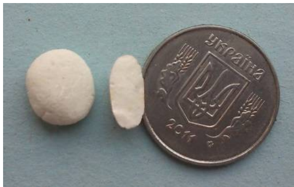
Рис. 4.1. Вигляд відпаленого і розколеного зразка
