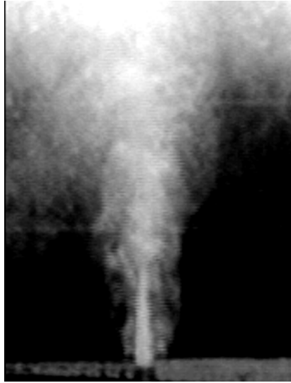
Рис. 95 Струміннь легкого охолоджувача проникає до шару розплаву знизу
