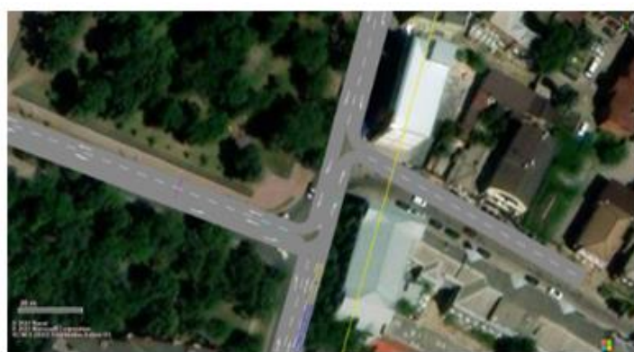
Рисунок 7 – Каналізування руху на перехресті площа Фейсрбаха – вул. Франківська - вул. Примерівська – пров. Фейсрбаха
