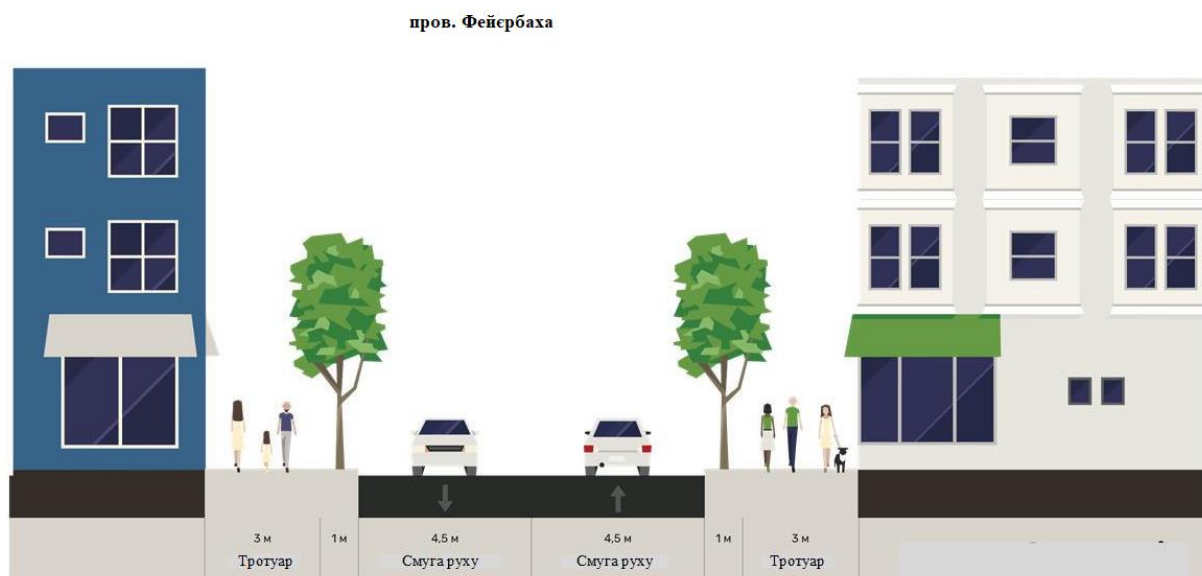
Рисунок 3 – Існуючий поперечний профіль елементів досліджуємої ділянки ВДМ
