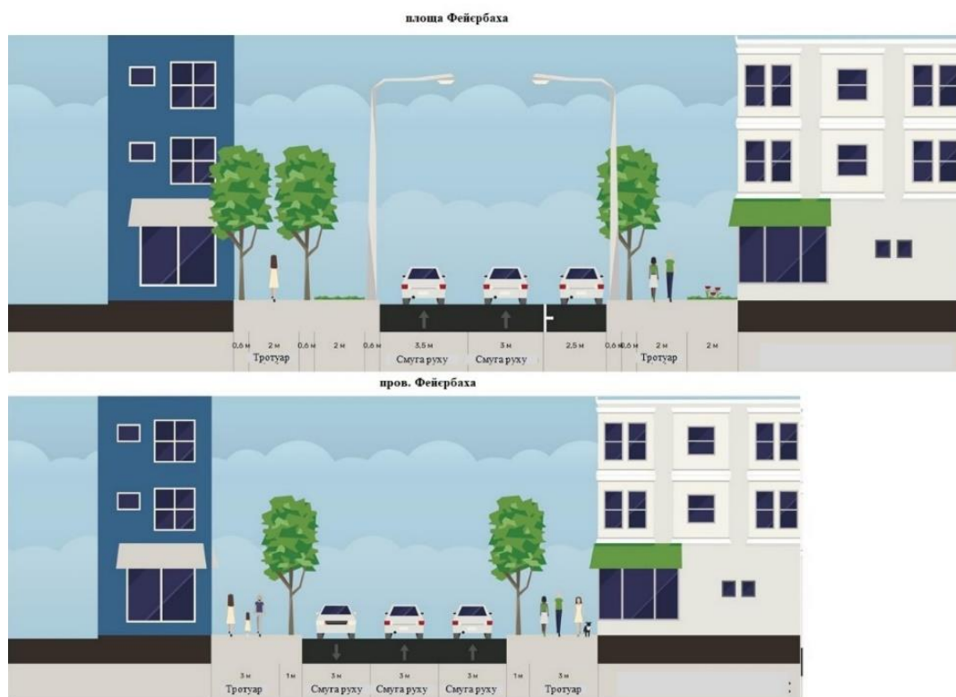
Рисунок 6 – Запропоновані поперечні профілі елементів досліджуємої ділянки ВДМ
